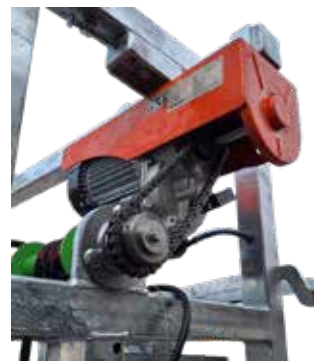
Antrieb Bauchgurte - elektrisch (Kette/Zahnrad neu abgedeckt)
